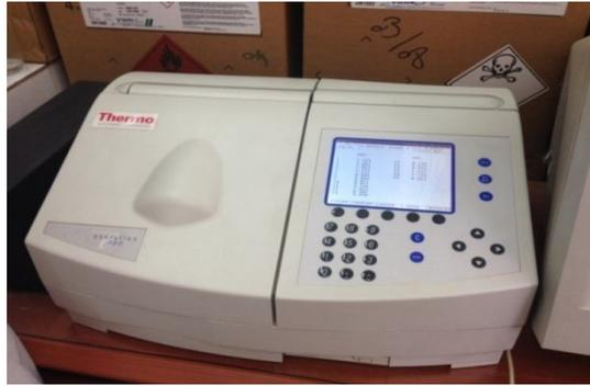
**Photo 11:** Spéctrophotomètre UV utilisé pour la lecture de l'absorbance
